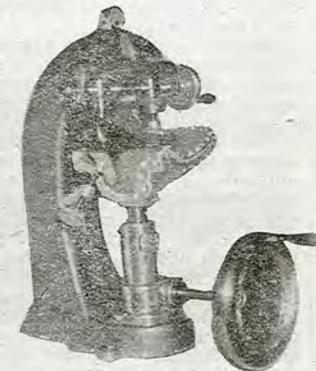
Con dispositivo de presión mecánico (Patente 2.1.308) accionada a mano y a motor monofásico o trifásico, según petición.
